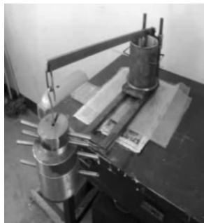
图2 饱和重塑土制样器
