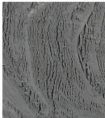
图 1 典型粉质黏土的灰度图像 Fig.1 Gray image of a typical silty clay
